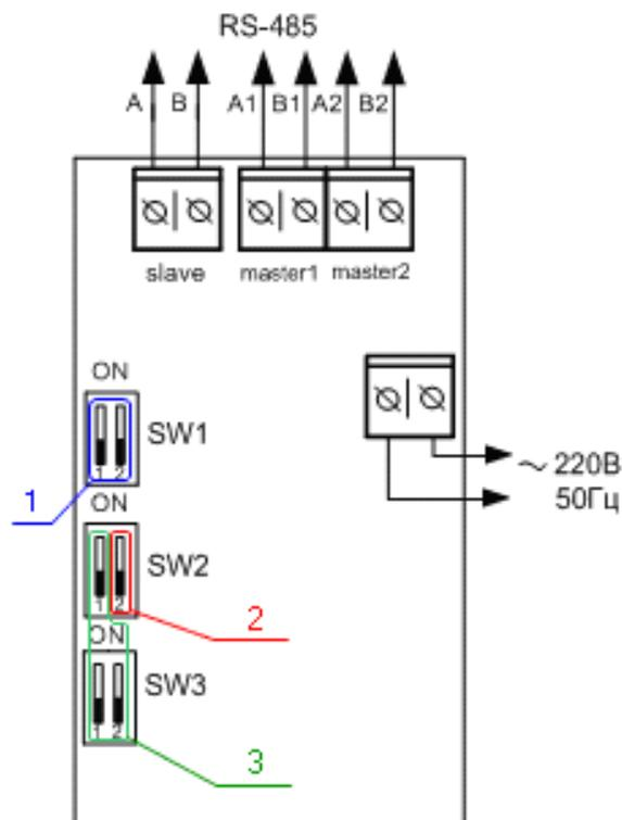
Рисунок А.1– Схема электрических подключений коммутатора
