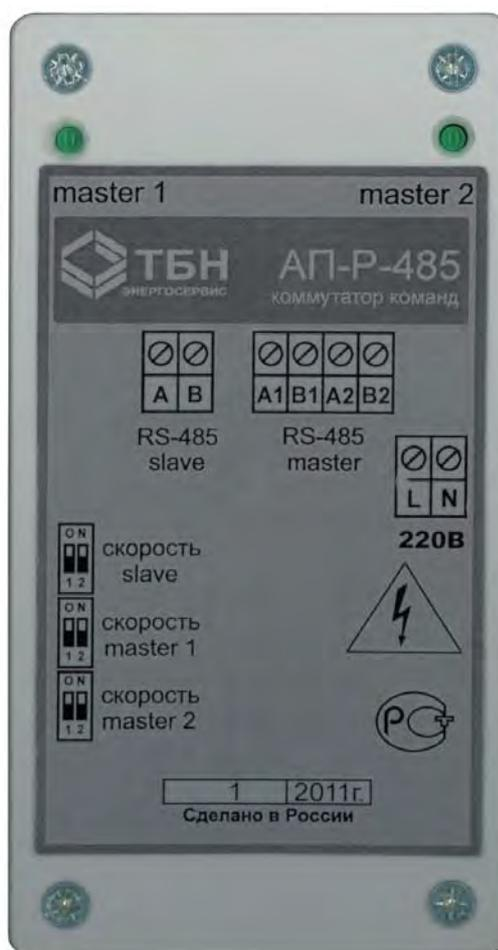
Рисунок 1 – Лицевая панель коммутатора
