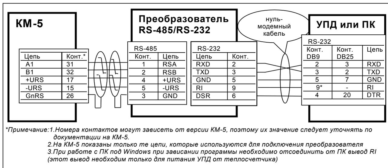
Рисунок 1— Схема подключения одиночного КМ-5 к ПК или УПД через преобразователь интерфейса для съема информации
