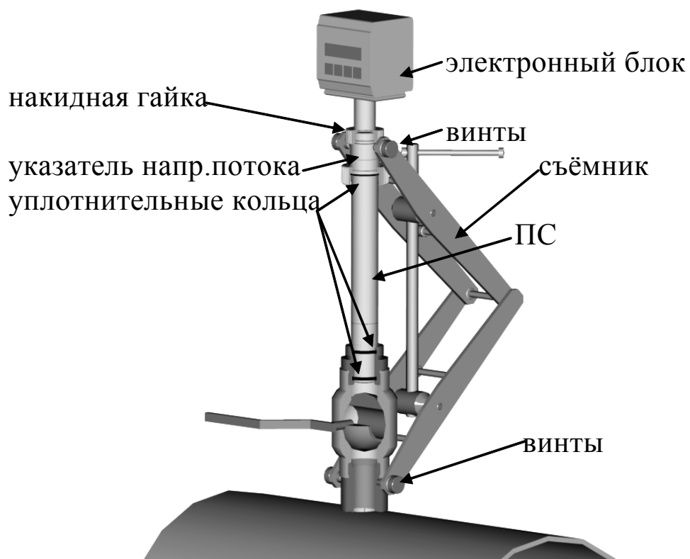
Рисунок 12 — Монтаж преобразователя (датчика) скорости ПРБ-3
