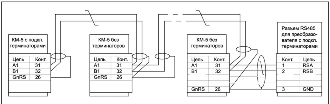
Рисунок 2 — Типовая схема сетевой конфигурации
