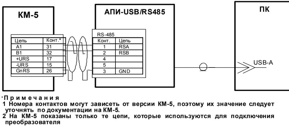
Рисунок 1 — Схема подключения одиночного КМ-5 к ПК через преобразователь интерфейса для съема информации
